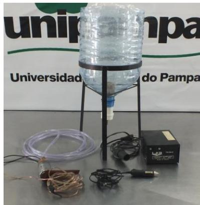
A mesma permite que se encaixe uma mangueira de silicone e que seja captada a água diretamente do meio (açude, rio lago, etc..). Também possibilita, o seu funcionamento em diferentes locais permitindo ser instalada um laboratório móvel (Figura 4), tem como fonte de energia, uma bateria 12 V, ou, energia elétrica.
