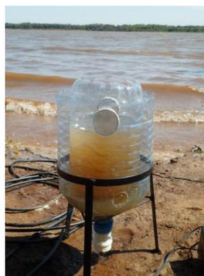
A capacidade de vazão da água da incubadora foi de 1 litro/minuto, o que proporcionou a aeração e a manutenção dos níveis adequados de qualidade de água, durante a realização do experimento. A vazão encontrada está de acordo com a observada no desenvolvimento de ovos e larvas por (GERKING 1978; BRANCO 1986; WOYNAROVICH & HÓRVATH 1983; VAZZOLER 1996 e HUET 1983).
