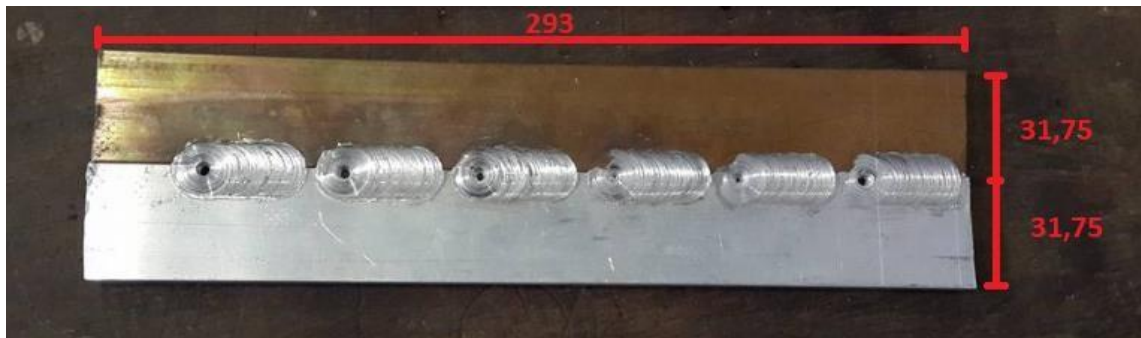
Figura 9 – Material base da solda.
