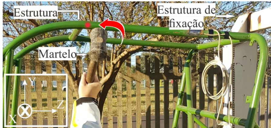
Figura 38 – Direção e posição do impacto na estrutura
