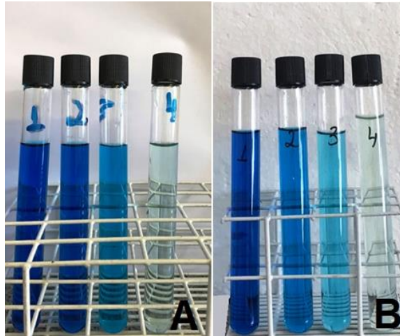
Figura 22 - Testes de massa do (A) CA e (B) CAP.
