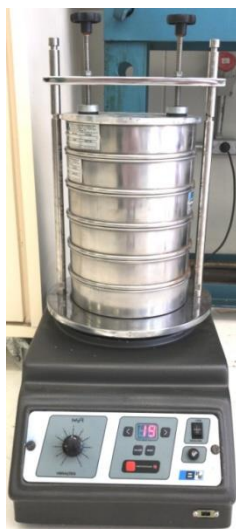
Figura 10 - Agitador eletromagnético e peneiras.
