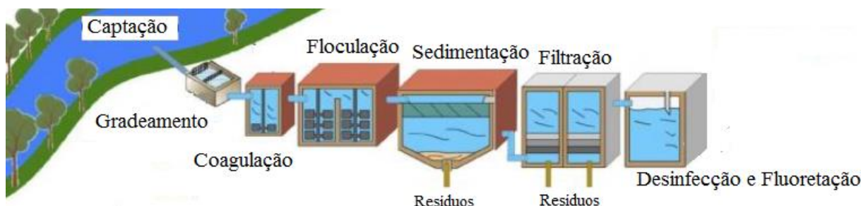
Figura 1 - Processos da estação de tratamento de água.
