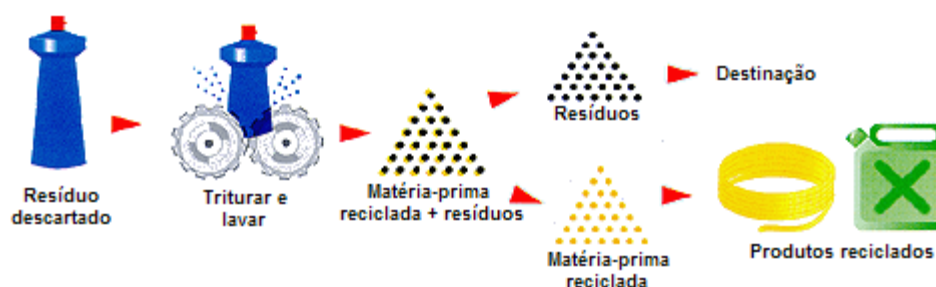
Figura 1 - Etapas da reciclagem mecânica. Fonte: www.plastivida.org.br , 2011.
