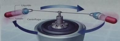
Uma centrífuga acelera o processo de decantação. Imagem sem escala; cores-fantasia.
