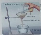
Uma mistura heterogênea sólido-líquido pode ser separada por filtração. O sólido fica retido no filtro enquanto o líquido passa por ele e é coletado (filtrado) em outro recipiente. Essa ilustração mostra como o procedimento pode ser feito em laboratório. Imagem sem escala; cores-fantasia.
