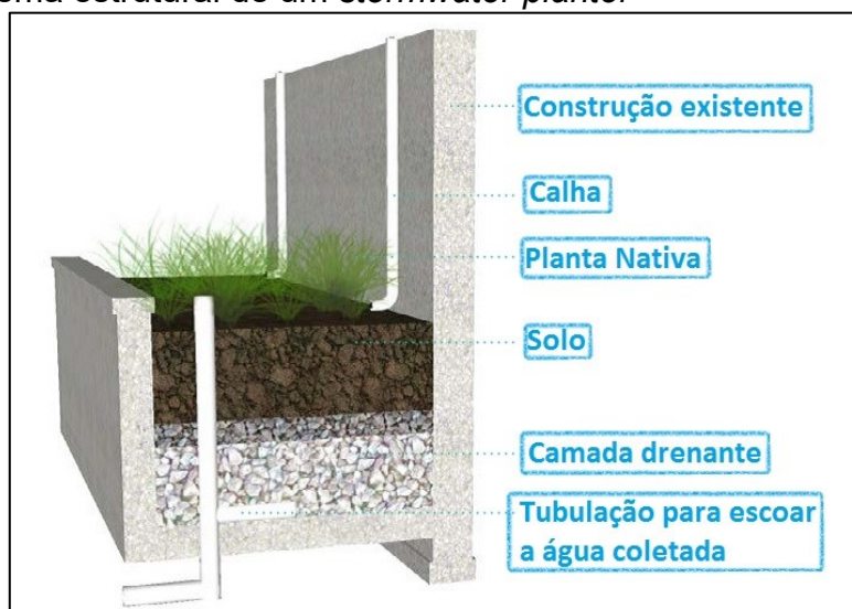
Figura 6 – Esquema estrutural de um stormwater planter
