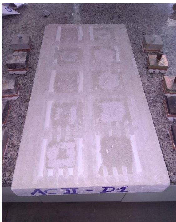
Figura 26: Ruptura ACII – D1
