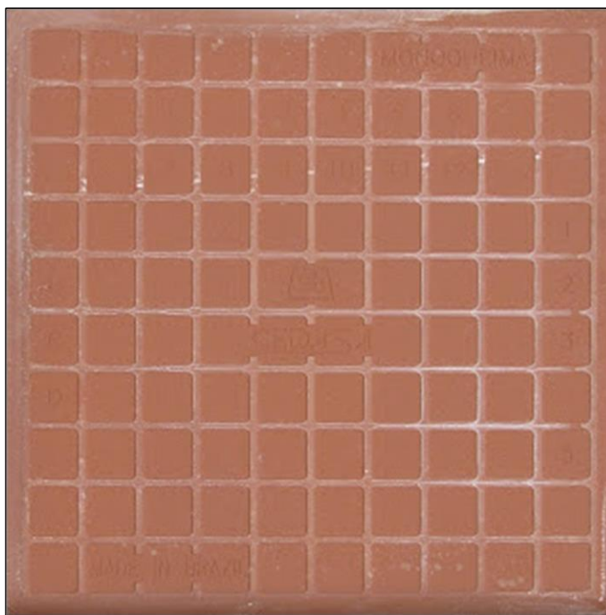
Figura 2: Face de colagem do revestimento cerâmico (Tardoz)
