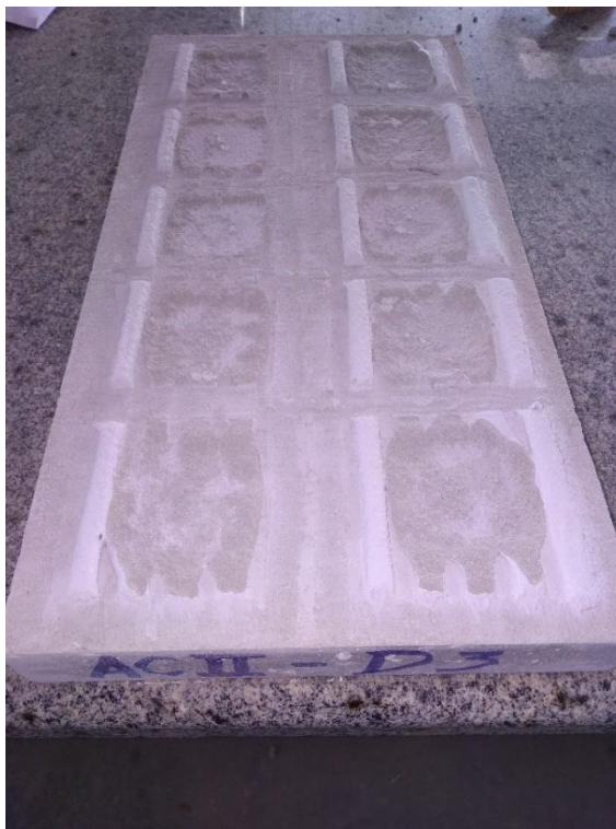
Figura 28: Ruptura ACII – D3
