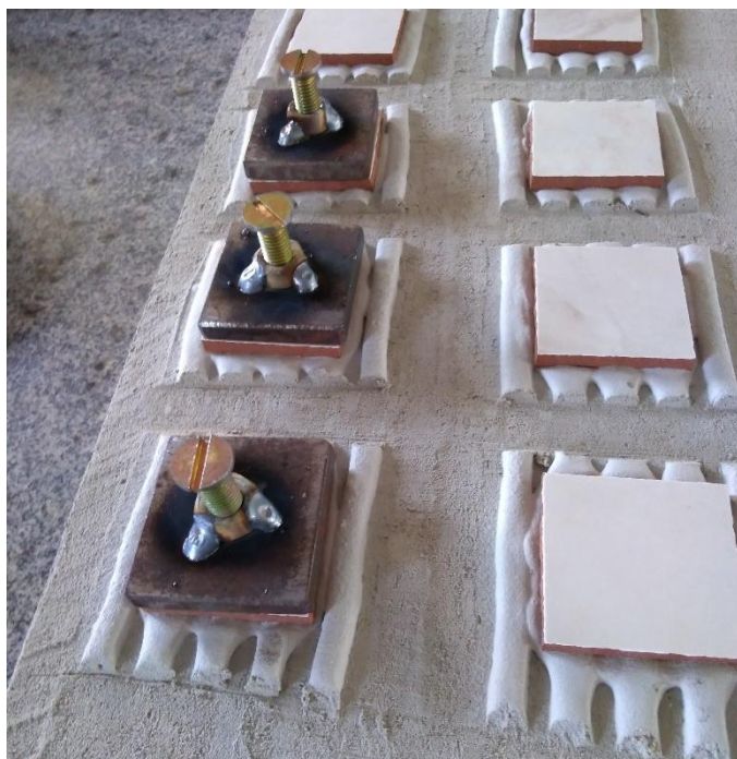
Figura 17: Colagem do elemento metálico
