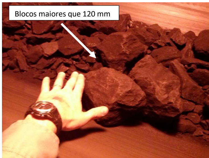
Figura 24 - Blocos de carvão com tamanho acima da especificação de alimentação do moinho.
