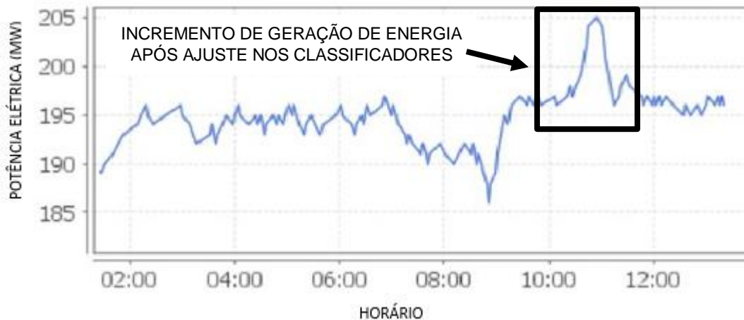
Figura 28 - Gráfico da oscilação de potência do gerador de energia elétrica.
