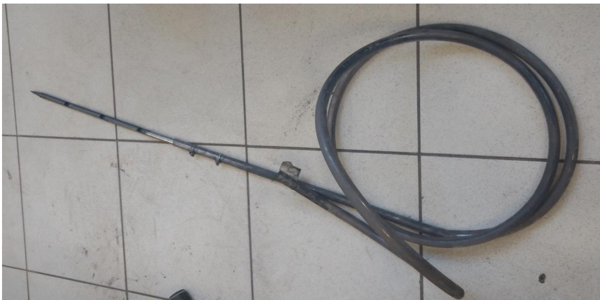
Figura 16 - Amostrador de carvão pulverizado confeccionado para a pesquisa.
