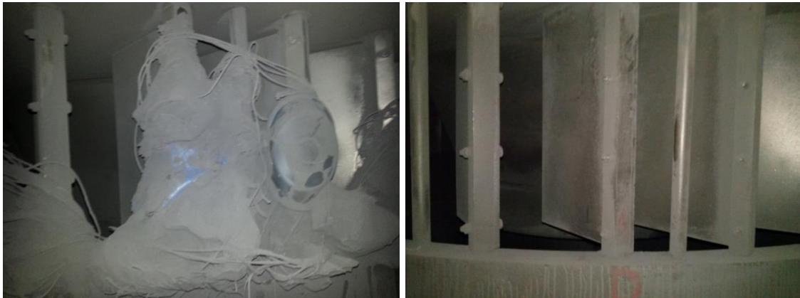
Figura 25 - Impurezas nas aletas do classificador (à esquerda), comparado com um classificador limpo (à direita).
