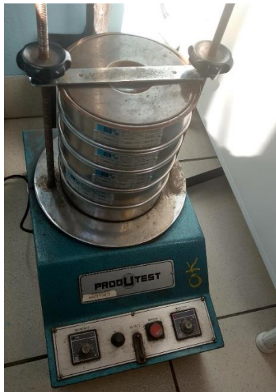
Figura 18 - Plataforma vibratória no processo de peneiramento das amostras de carvão.
