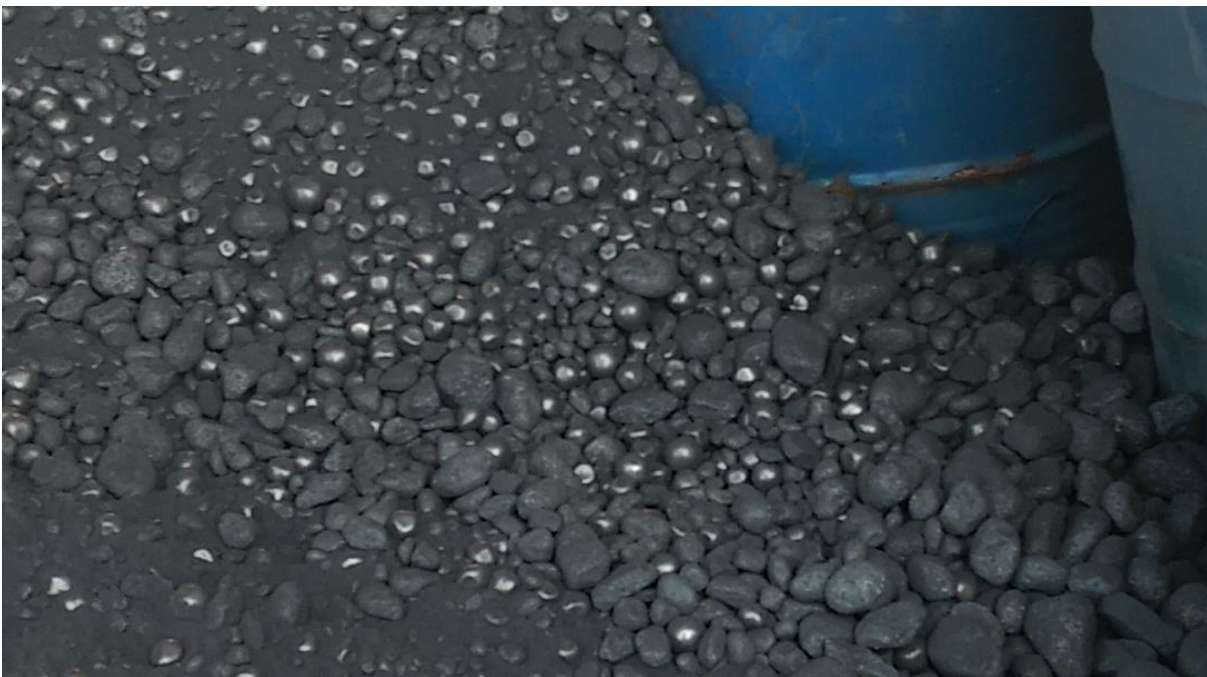
Figura 23 - Polpa retirada do moinho, com carvão, corpos moedores e pedras calcárias que não foram moídas
