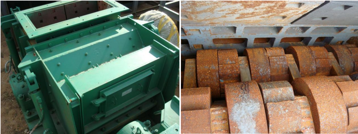
Figura 6 - Fotos externa e interna do britador de carvão.
