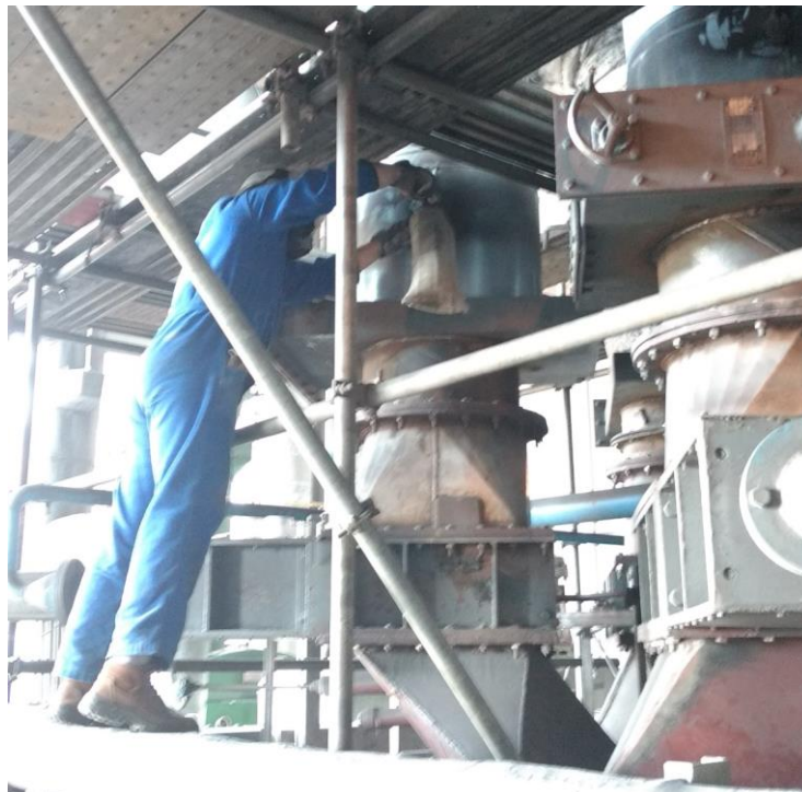
Figura 15 - Operador realizando a coleta de amostras de carvão pulverizado.
