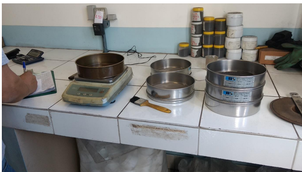
Figura 19 - Processo de pesagem das amostras de carvão retidas nas peneiras
