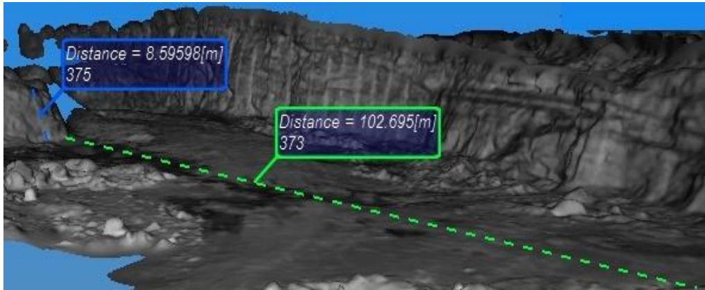
Figura 10: Dimensões obtidas com o laser scanner Stonex X-300 da Bancada n° 1: o comprimento da face da bancada é 8,5959(m) e a dimensão da praça de trabalho (WB) de 102,695(m).
