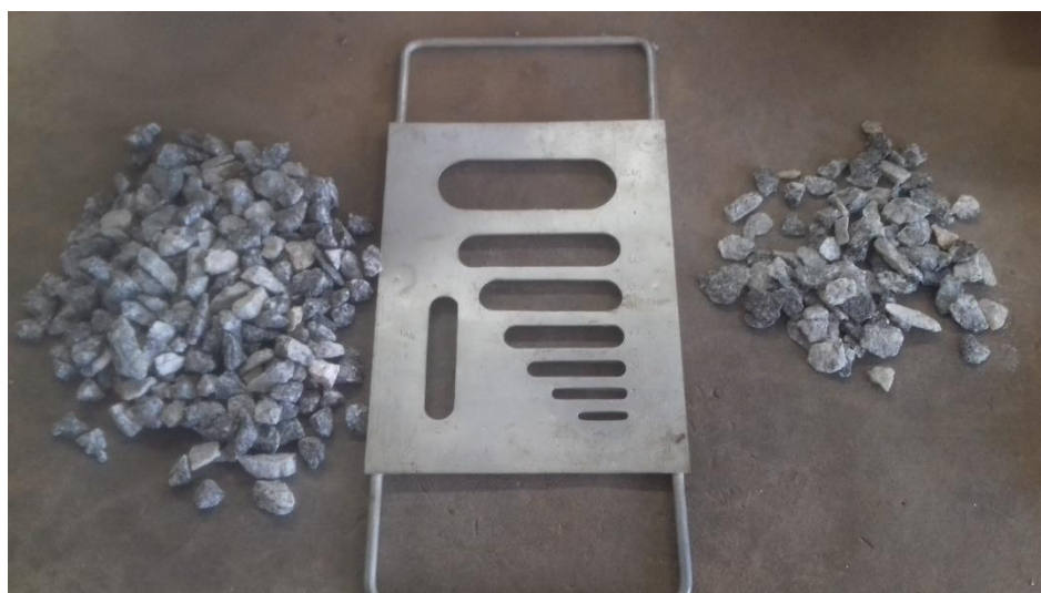
Figura 36 – Ensaio de lamelaridade pelo uso da placa do DAER.
