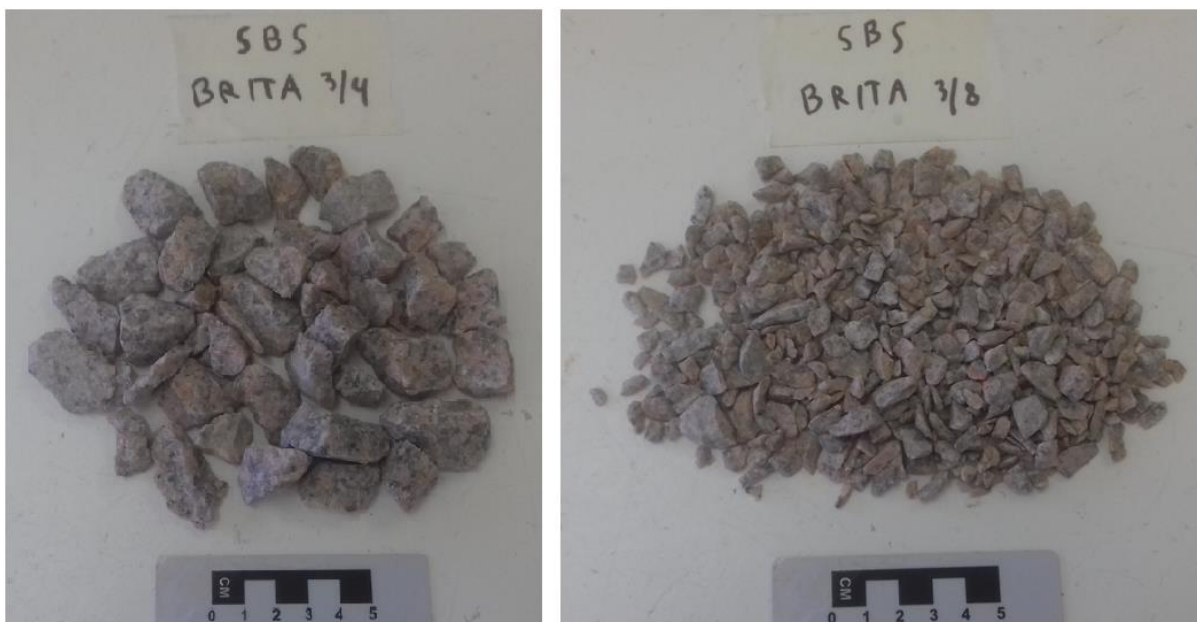
Figura 31 - Amostras britadas coletadas nas frações 3/4 e 3/8
