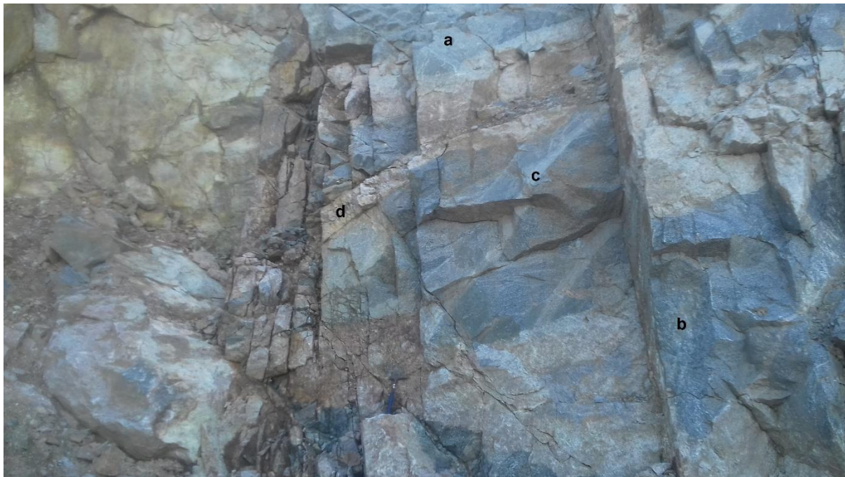
Figura 11 - Foto de uma parte da jazida onde fica bem evidente a heterogeneidade da mesma. Em (a) ocorre monzogranito, em (b) granodiorito, em (c) veios de pegmatito e em (d) rocha alterada
