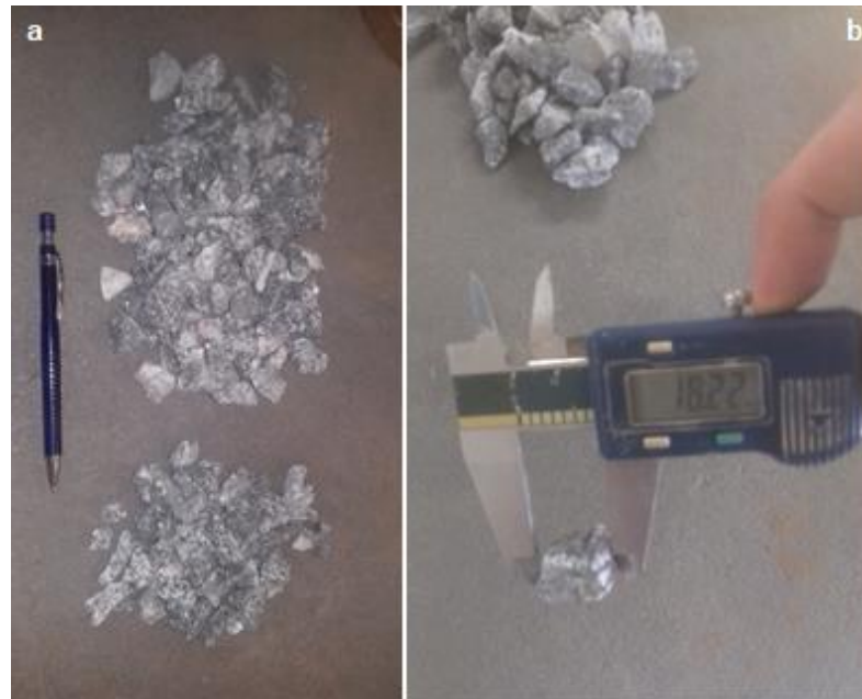
Figura 35 – Ensaio de índice de lamelaridade pelo método do paquímetro. Em (a) as amostras selecionadas para o ensaio e em (b) um agregado sendo ensaiado
