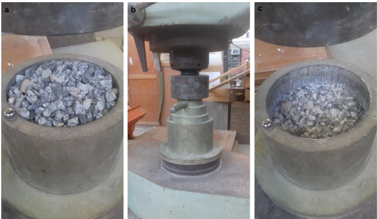
Figura 41 – Ensaio de esmagamento. Em (a) as amostras utilizadas, em (b) o equipamento realizando o ensaio e em (c) as amostras após o ensaio
