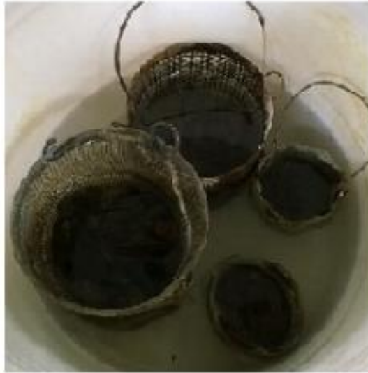
Figura 42 - Agregado imerso na solução
