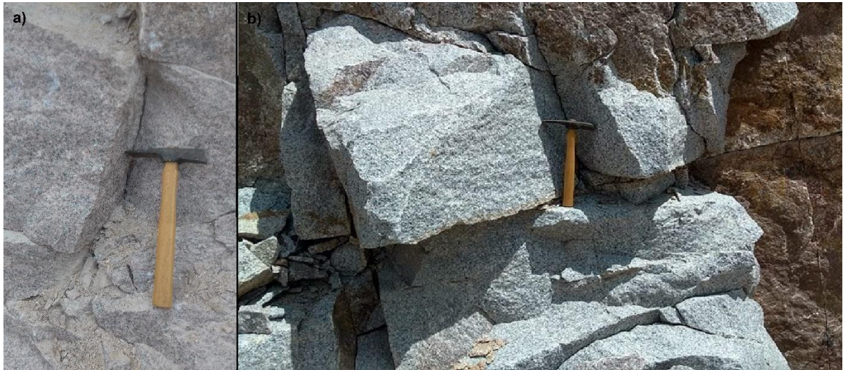
Figura 23 - Diferentes tipos litológicos encontrados na pedreira. Em (a) o sienogranito e em (b) o monzogranito
