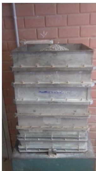
Figura 32 – Peneiras utilizadas no ensaio de granulometria
