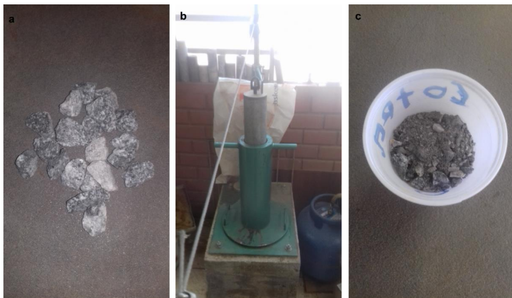
Figura 40 – Ensaio de perda ao choque no aparelho Treton. Em (a) os 20 grãos escolhidos para o ensaio, em (b) o aparelho Treton utilizado e em (c) os grãos após o ensaio
