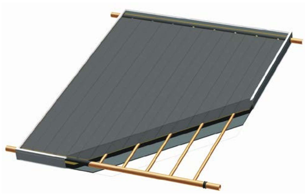
Figura. 16 – Corte de um coletor plano. Fonte: www.solares-online.com.br
