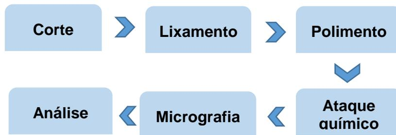
Figura 4 - Processo metalográfico
