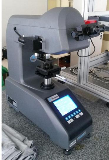
Figura 6 – Microdurômetro de modelo MicroMet 6010
