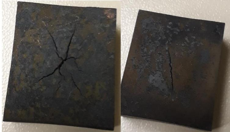
Figura 10 – Amostra sem acabamento no laser submetida a 1000°C
