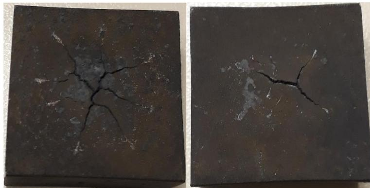
Figura 9– Amostra com acabamento no laser submetida a 1000°C
