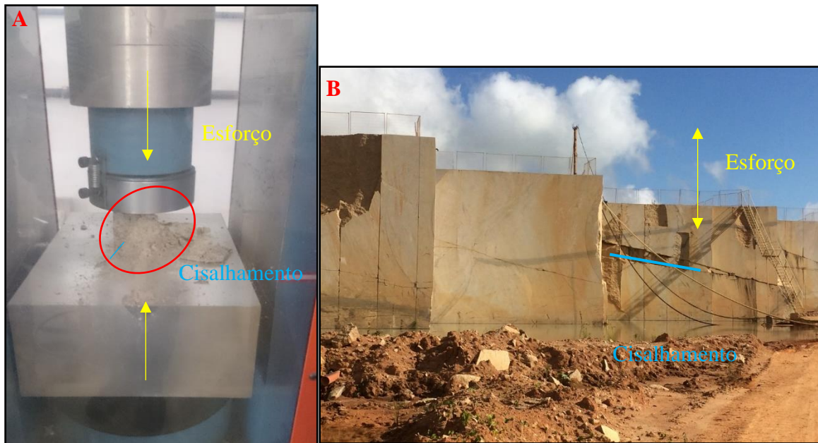
Figura 32 – Foto A: Compressão uniaxial levando ao cisalhamento da rocha. Foto B: Esforços relativos ao alívio de peso e uso de explosivo, onde o padrão de cisalhamento segue uma angulação próximo aos 30°.
