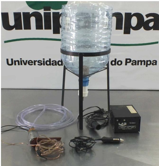
Figura 19: Incubadora portátil Nupi12 utilizada para manter os padrões de qualidade da água do local de captura dos peixes.
