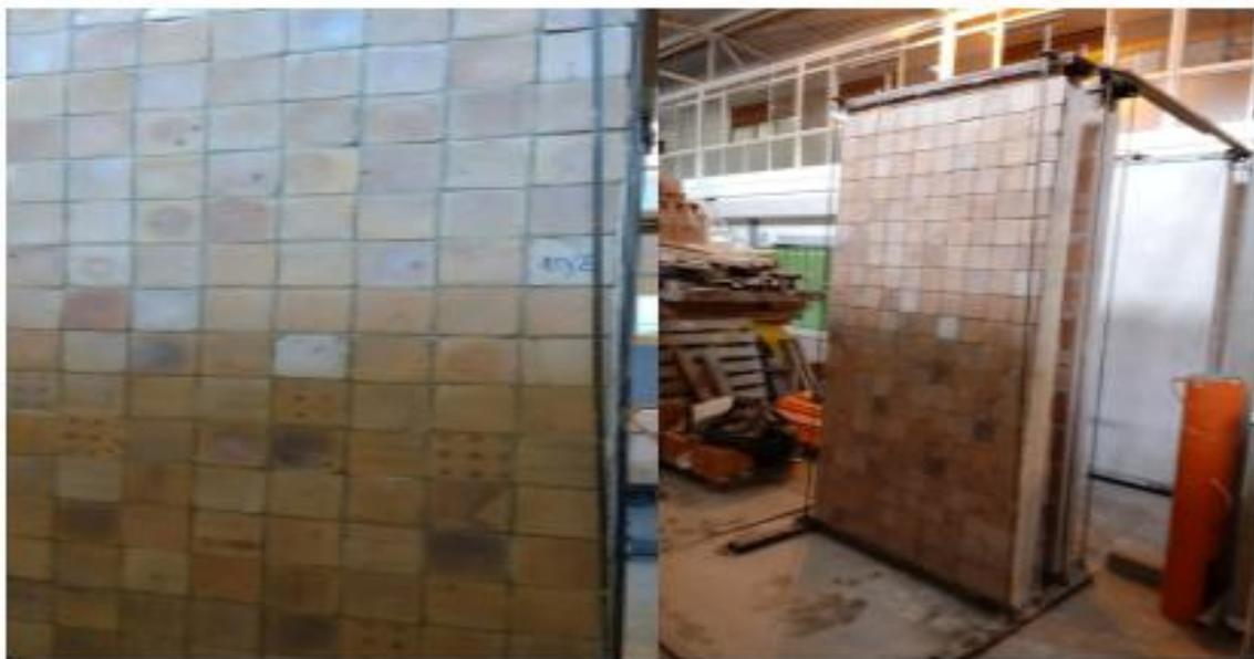
Figura 17- Parede restringida por porte metálico (a) e (b)
