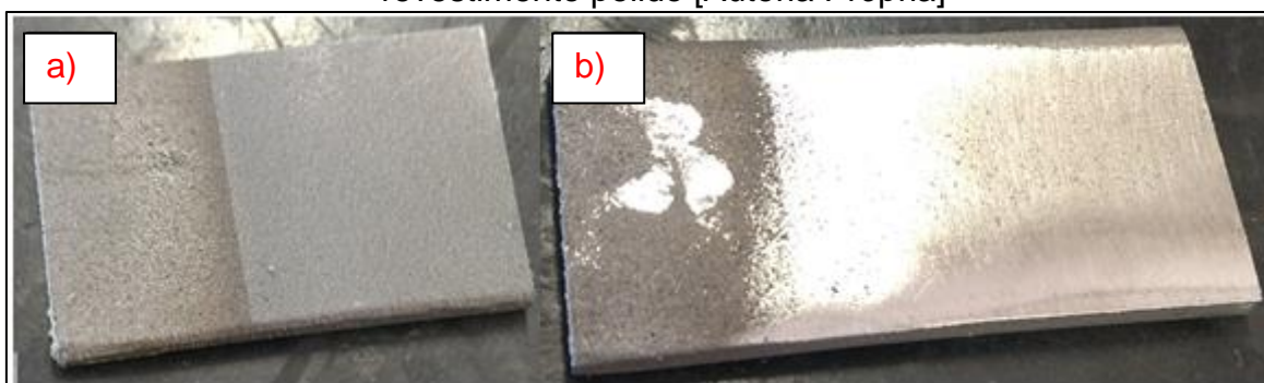
Figura 5 – Materiais fornecidos. a) Material com revestimento bruto e b) Material com revestimento polido [Autoria Própria]
