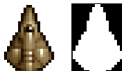
Figura 9 – Representação da matriz do sprite para detectar a colisão com pixel perfect
