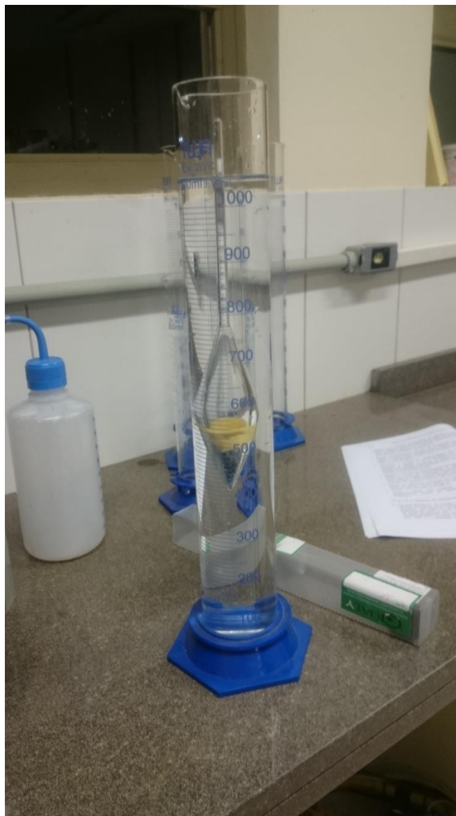
Figura 14: Preparo da solução de NaOH para determinação da granulometria do solo. UNIPAMPA – Campus Alegrete. Fonte: AYRES, 2018.
