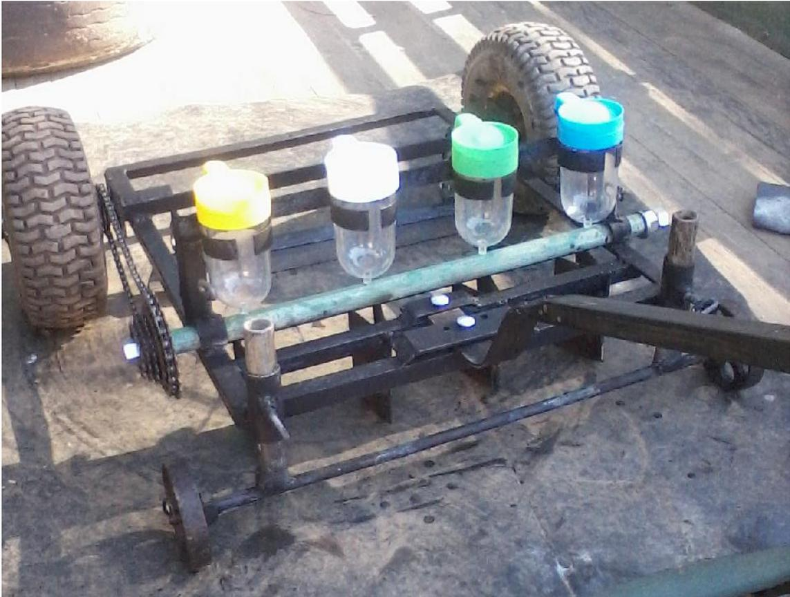
**Figura 1:** Protótipo da semeadora em construção.
