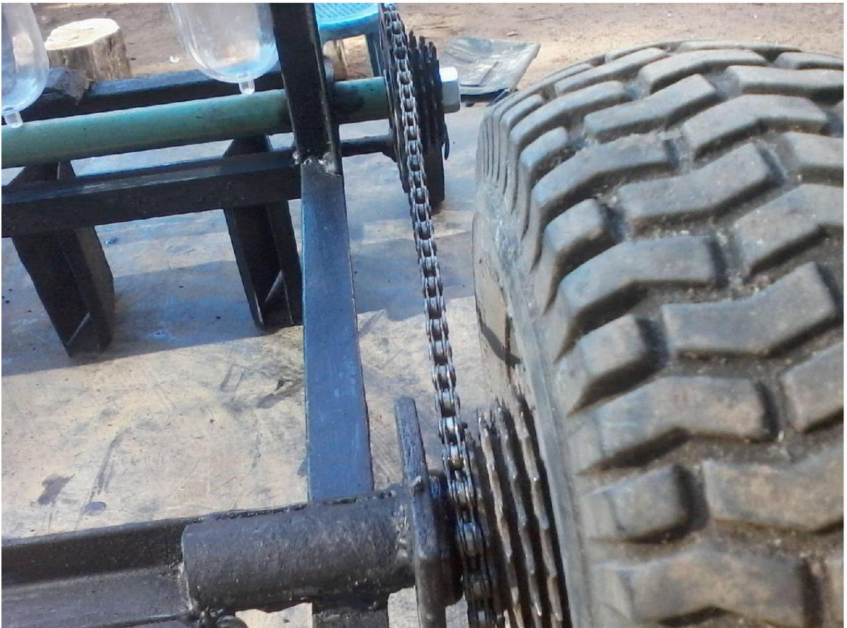
**Figura 14:** Protótipo: Detalhe do sistema de regulagem de espaçamento.
