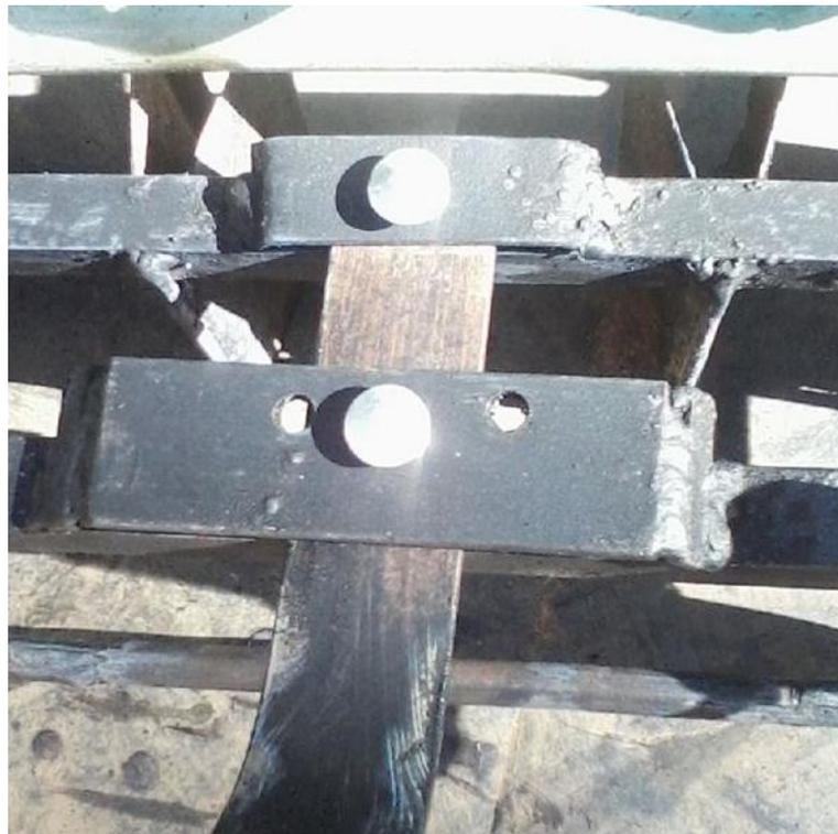
**Figura 2:** Protótipo: Detalhe do sistema de regulagem ambidestro.
