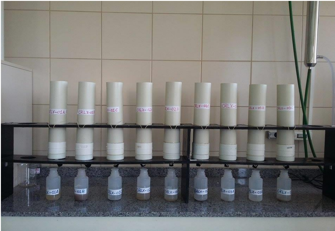
Figura 26 – Colunas de lixiviação utilizadas para a obtenção do percolado avaliado, bem como os solos matriz e lixiviado.
