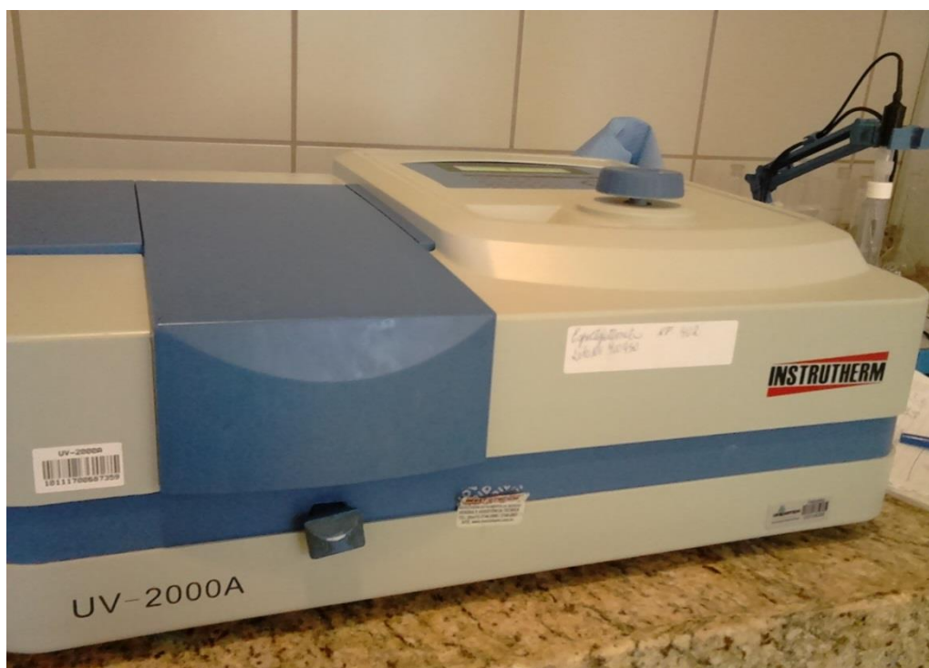
Figura 13 - Espectrofotômetro utilizado nas análises físico-químicas.
