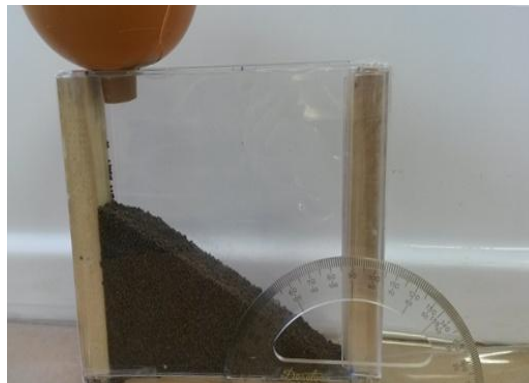
Figura 18- Aparato para determinação do ângulo de repouso
