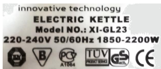
Figura 1 – Etiqueta de especificações técnicas de uma jarra elétrica
