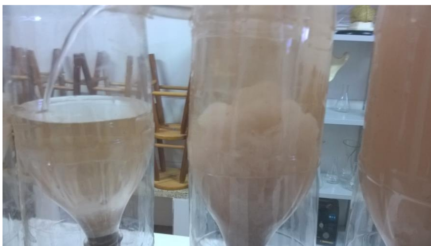
Figura 11 - Processo de floculação no protótipo da ETA
