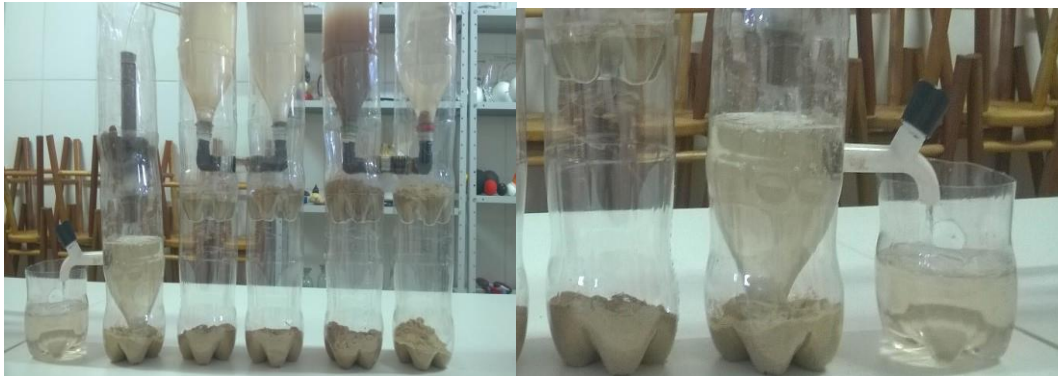
Figura 12 - (a) Demonstração do protótipo em funcionamento e (b) detalhe do processo de filtração
