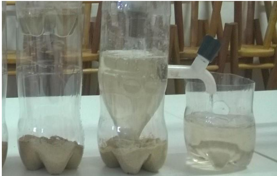
Figura 9- Processo de filtração no protótipo da ETA
