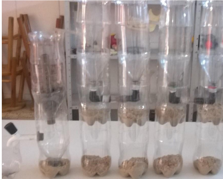
Figura 6 - Montagem do protótipo da ETA
