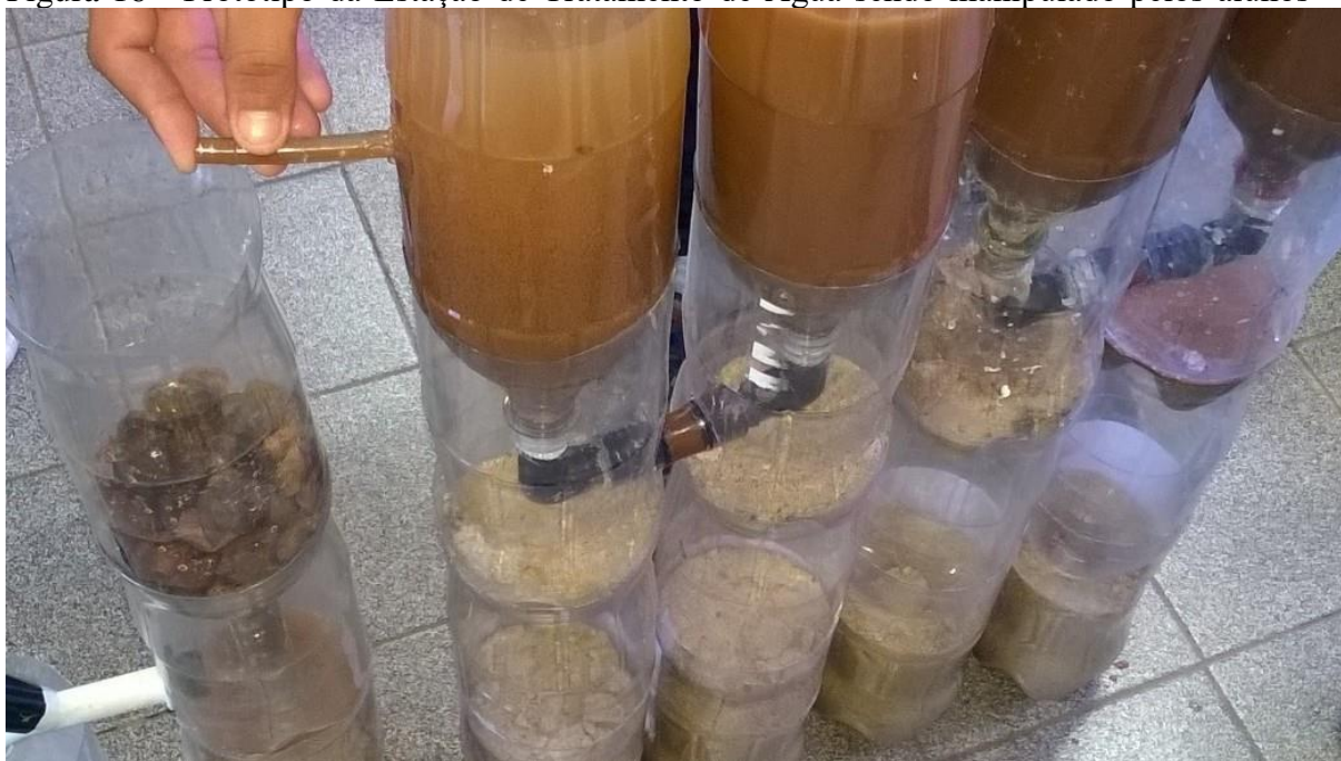
Figura 16 - Protótipo da Estação de Tratamento de Água sendo manipulado pelos alunos
