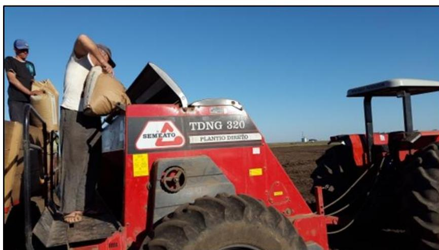
Figura 5 - Abastecimento da semeadora-adubadora de forma manual.
