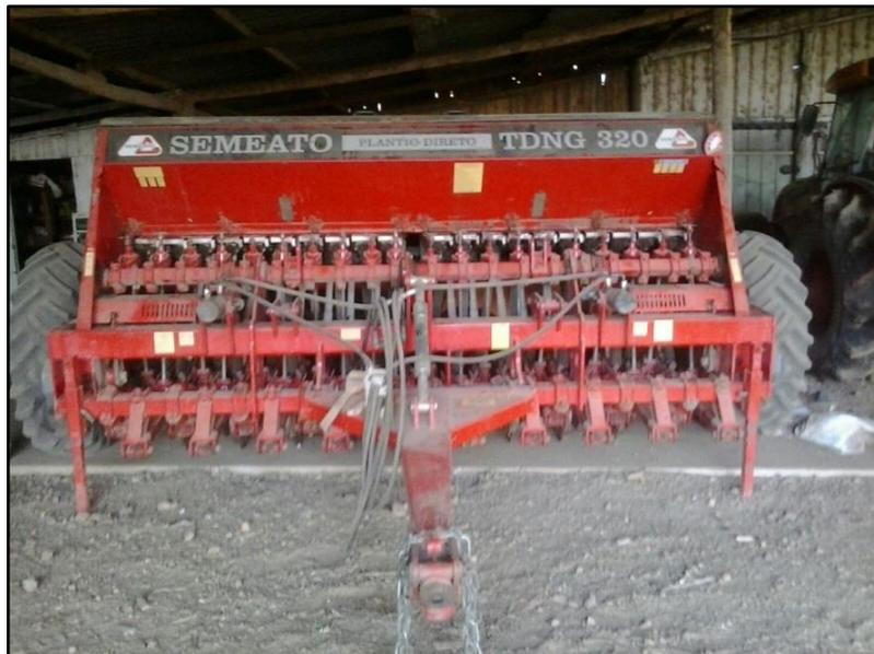
Figura 2 - Semeadora-adubadora da marca Semeato e modelo TDNG 320.
