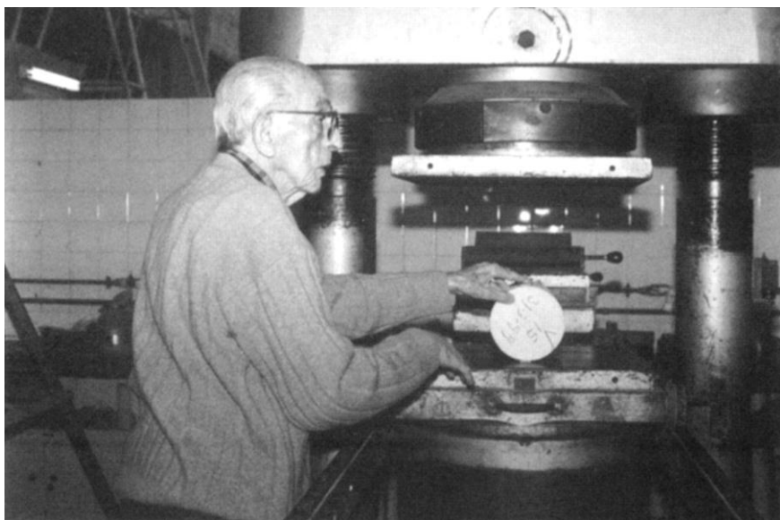
Figura 5 - Fernando Luiz Lobo Barbosa Carneiro, ou mais conhecido como Lobo Carneiro, preparando um ensaio de compressão diametral de concreto
