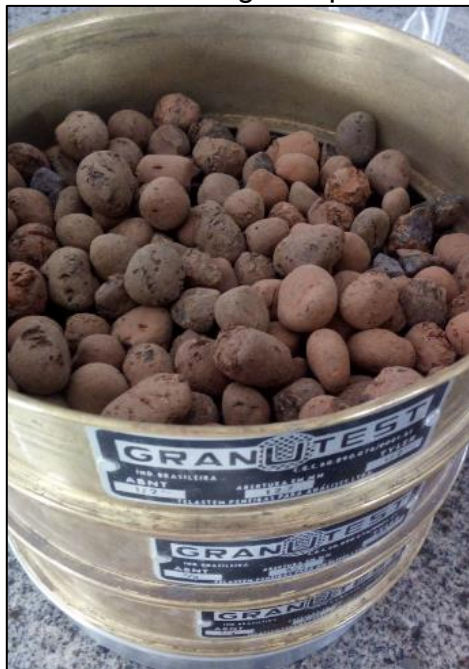
Figura 10 – Ensaio de granulometria da argila expandida CINEXPAN 2215
