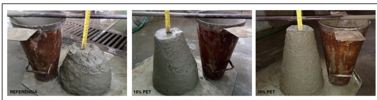
Figura 16 – Ensaio de abatimento
