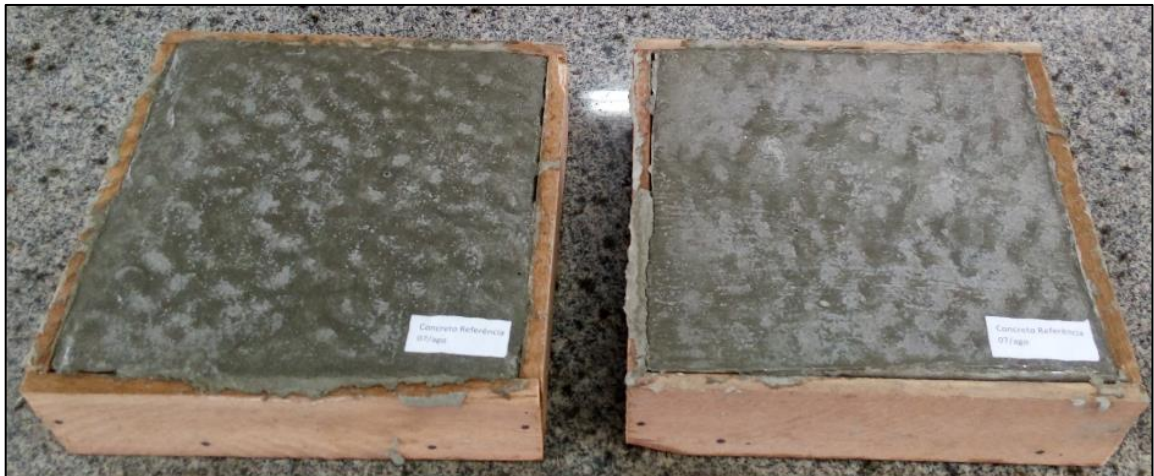
Figura 21 – Placas de concreto para análise da condutividade térmica
