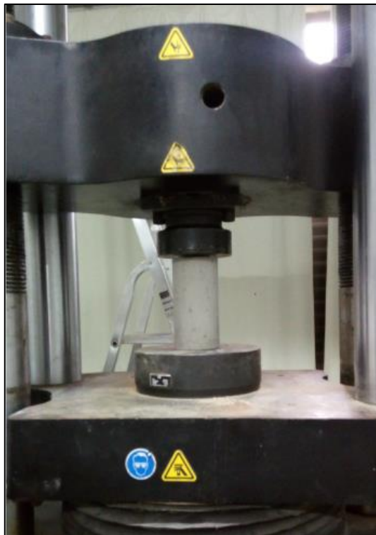
Figura 18 – Ensaio de resistência à compressão axial
