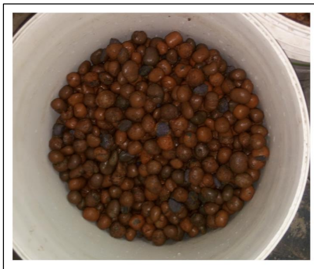
Figura 14 – Argila expandida após imersão em água por 24 horas
