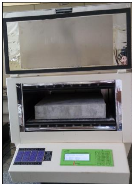
Figura 20 – Equipamento utilizado para o ensaio de condutividade térmica
