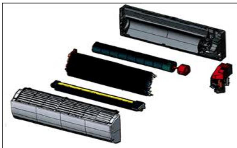
Figura 9 - Unidade evaporadora de Split
