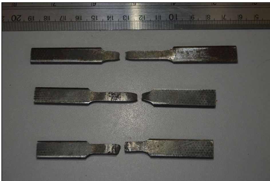
Figura 19 – CP após fratura.
