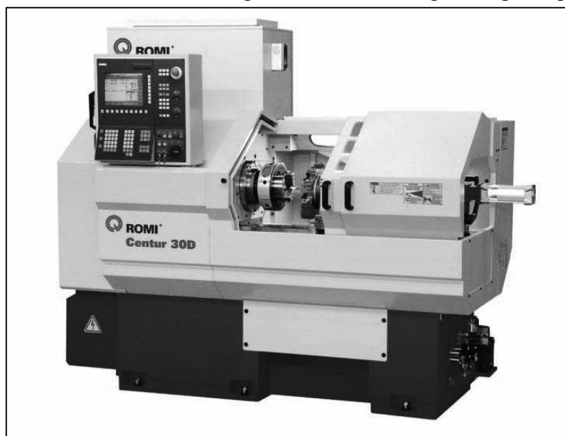
Figura 16 – Torno CNC utilizado na usinagem da célula de carga e corpo de prova
