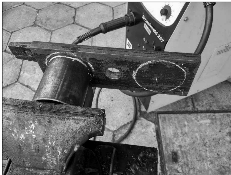
Figura 27 – Soldagem do suporte fixador
