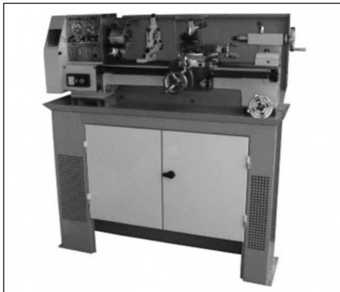
Figura 17 - Torno manual utilizado para ajustes de medidas nos tubos
