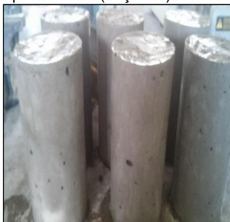
(b) Corpos de prova desmoldados.
