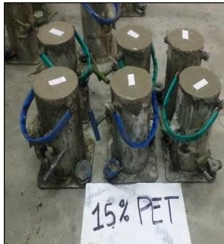
b) Corpos-de-prova após a moldagem
