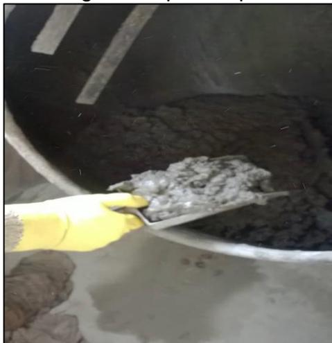
a) Concreto com 15% de agregado de PET
