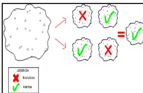
Figura 5 - Diagrama do processo de quarteamento de RCC, com divisão da amostra em quatro partes e após, seleção de duas partes opostas para uma nova amostra.
