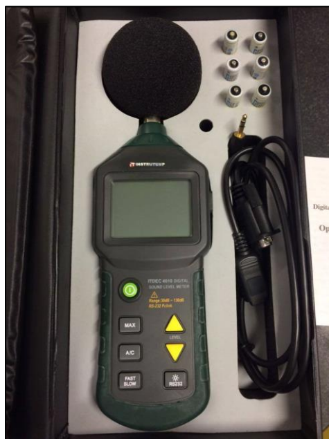
Figura 12 - Decibelímetro INSTRUTEMP ITDEC 4010
