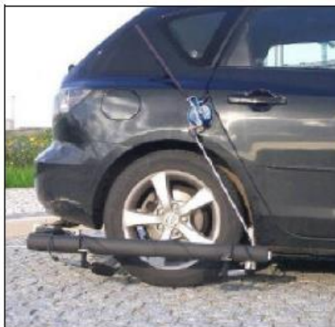
Figura 9 - Microfones acoplados na roda do próprio veículo no método CPX
