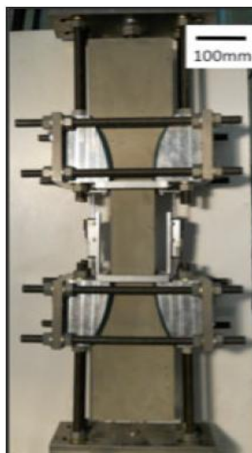
Figura 10 – Chapas de aço e parafusos no corpo de prova
