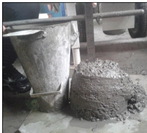
Figura 18 – Quarta concretagem, abatimento 180 mm
