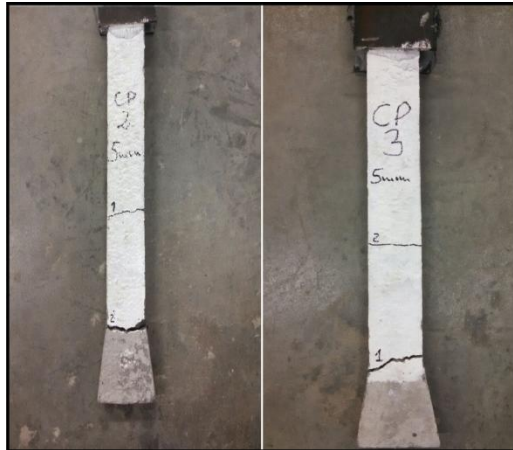
Figura 22 – Fissuras nos corpos de prova CP2_5mm e CP3_5mm
