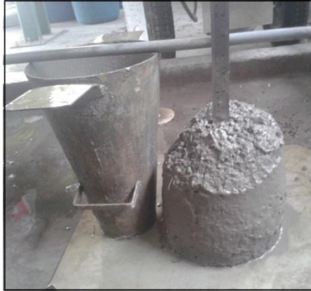
Figura 16 – Segunda concretagem, abatimento 160 mm
