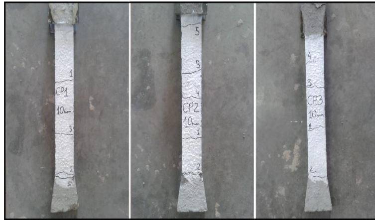
Figura 24 – Fissuras nos corpos de prova CP1_10mm, CP2_10mm e CP3_10mm
