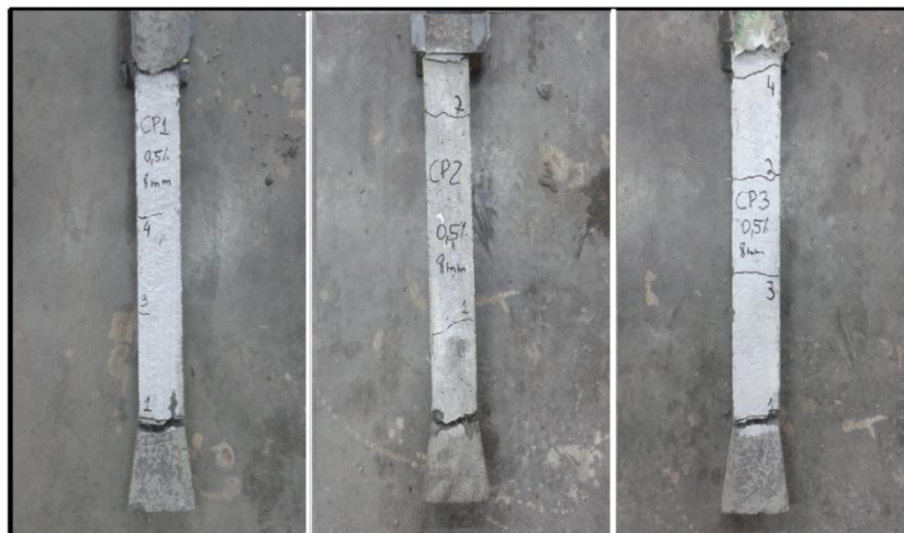
Figura 27 – Fissuras nos corpos de prova CP1_0,15%_8mm, CP2_0,15%_8mm e CP3_0,15%_8mm
