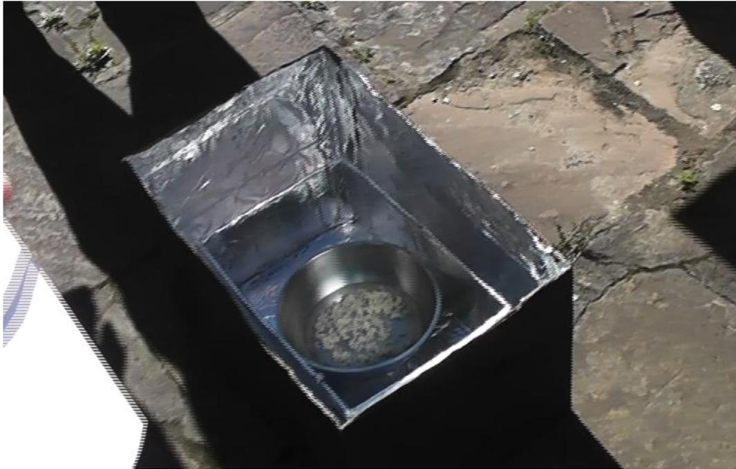
A figura 10 mostra a aplicação do conhecimento num experimento simples, mas bastante informativo sobre a energia solar. O experimento consistiu em mostrar que a energia solar pode ser transformada em energia térmica e que a água aquecida pode cozinhar macarrão instantâneo. As alunas comentaram sobre o tempo de cozimento de alguns alimentos, as possibilidades alternativas de utilização de um fogão solar e a adaptação desse dispositivo de acordo com as regiões brasileiras.
