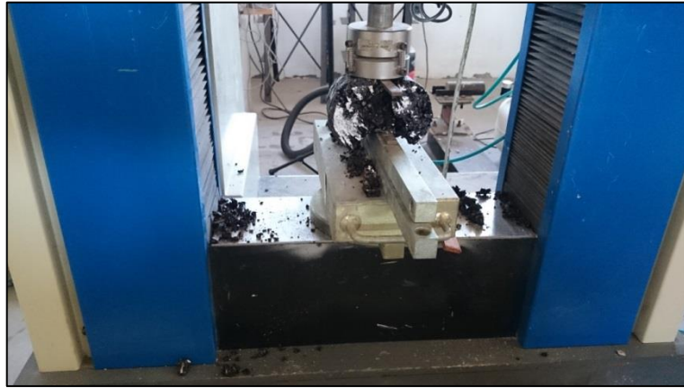
Figura 37- Corpo de prova de mistura asfáltica com adição no ensaio de RT
