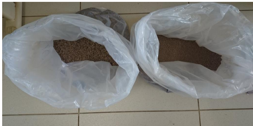
Agregados peneira N10 e N40
