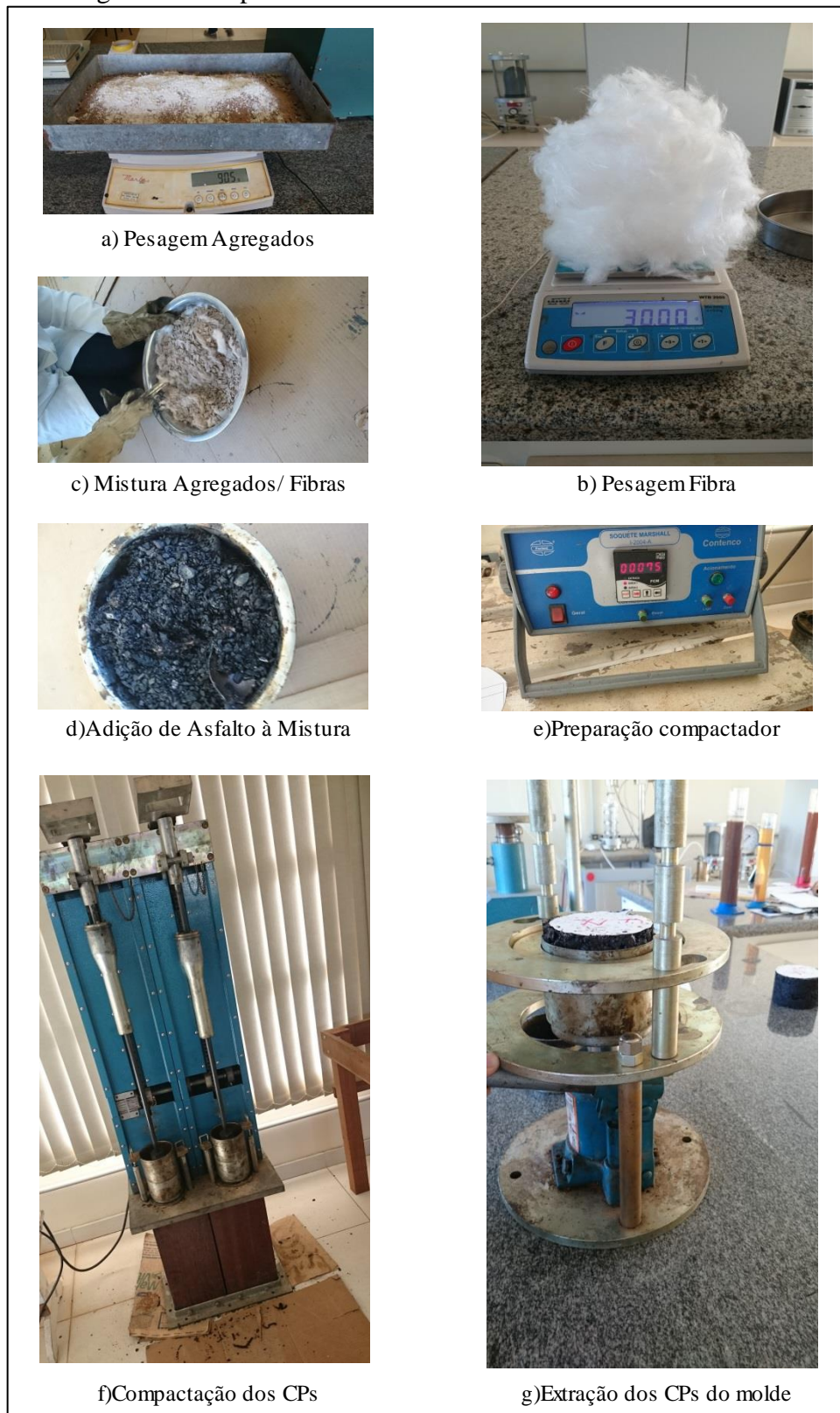
Figura 26- Moldagem dos Corpos de Prova.
