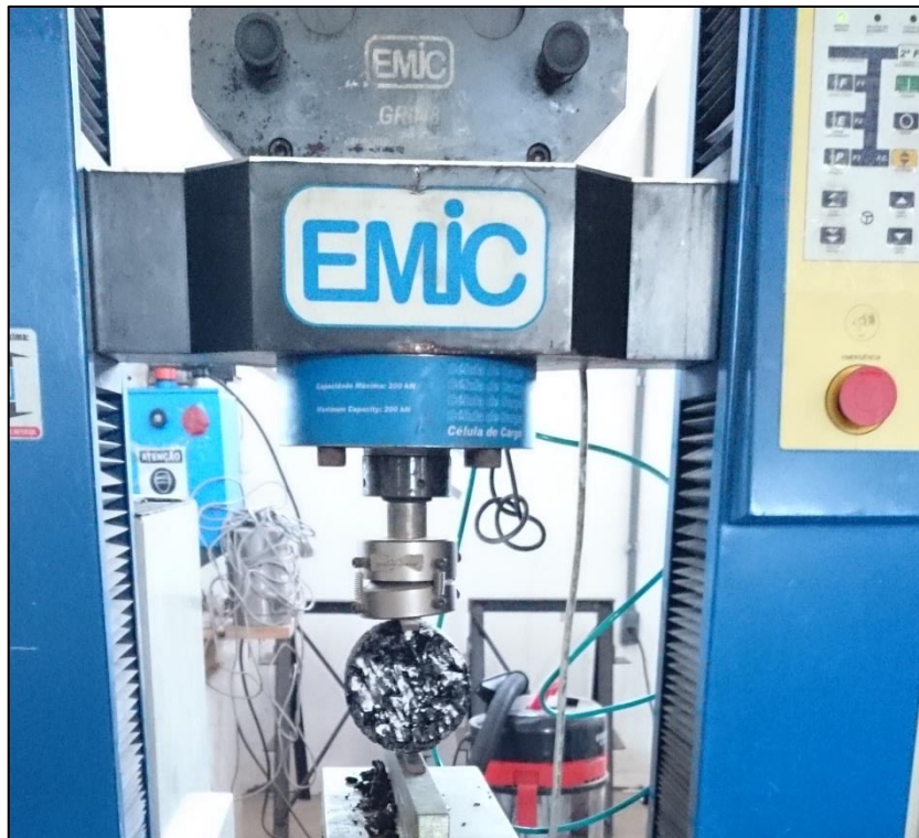
Figura 35- Posicionamento do CP com adição de fibras no equipamento.
