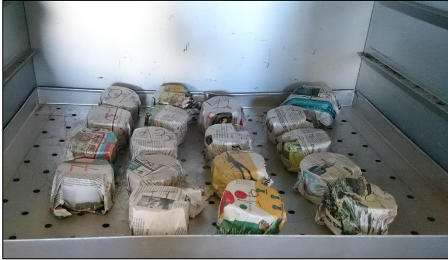
Figura 32- Armazenamento dos CPs em estufa à 25°C
