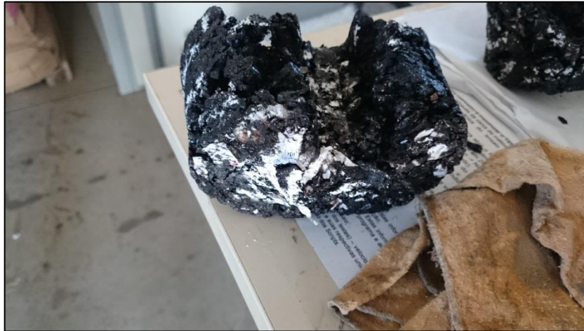
Figura 36- CP com adição de fibras após a realização do ensaio
