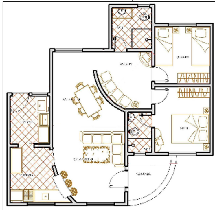
Figura 8 – Planta baixa de uma residência com paredes não-lineares
