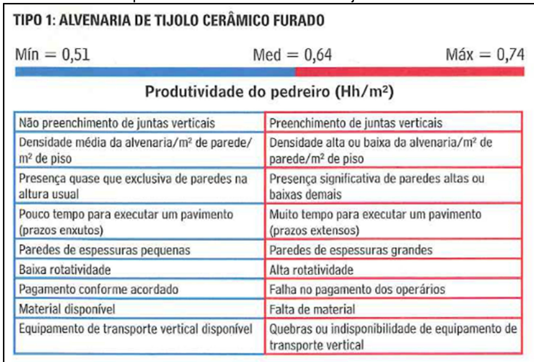
Figura 22 – Índices de produtividade da alvenaria de tijolo cerâmico furado
