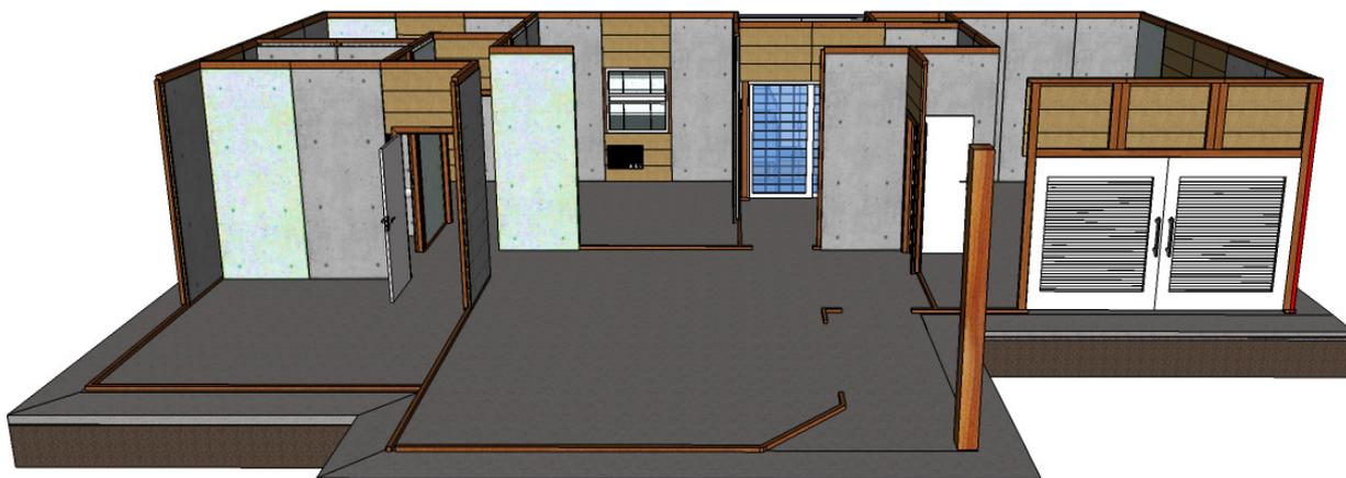
Figura 19: Vista geral do travamento entre os painéis
