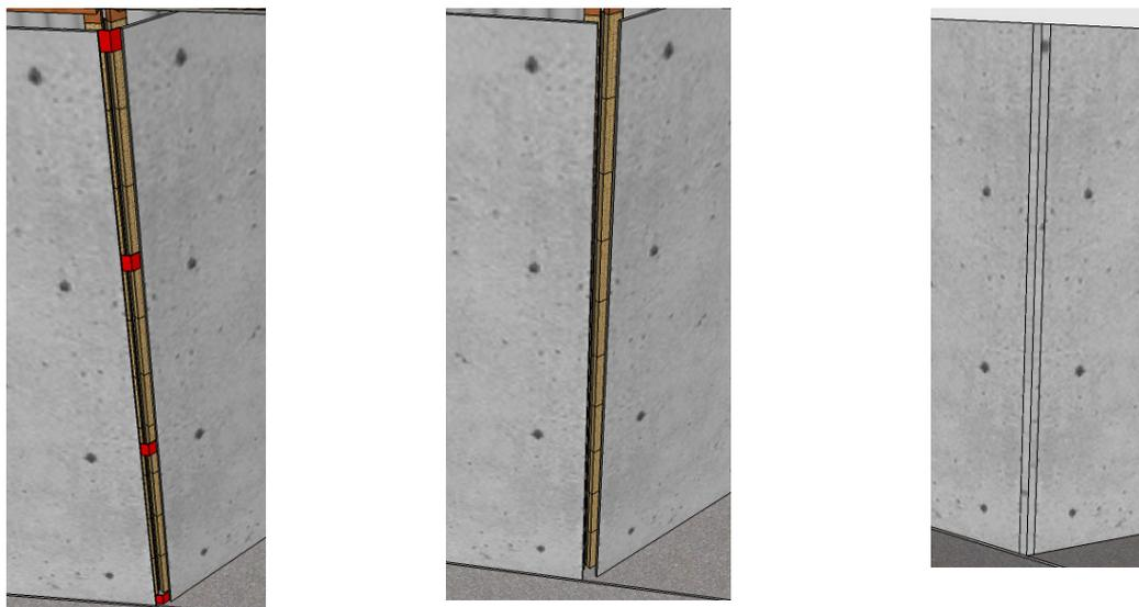
Figura 43: Detalhe com cantoneira metálica
