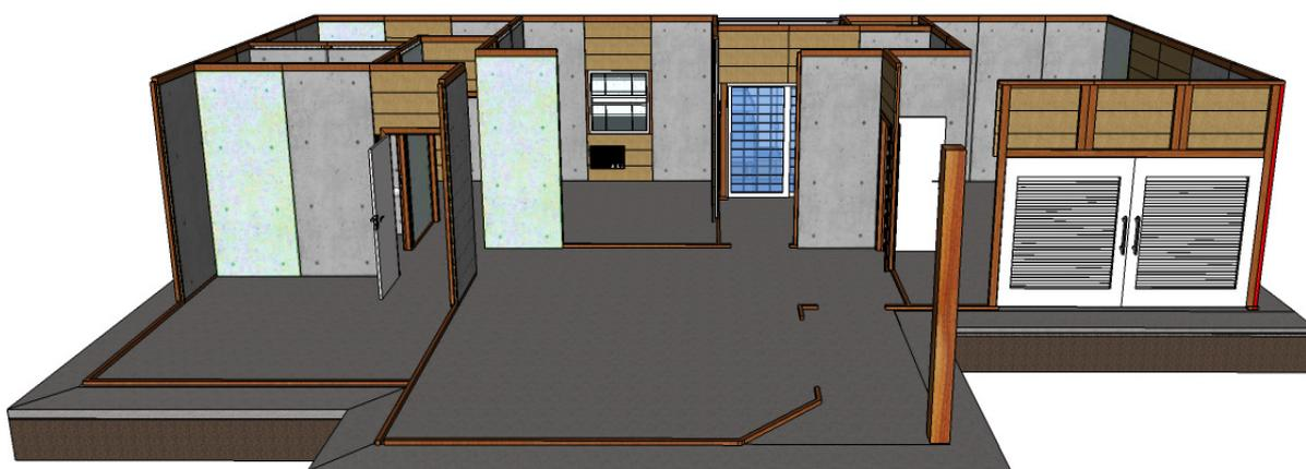
Figura 56: Colocação dos painéis - fechamento vertical
