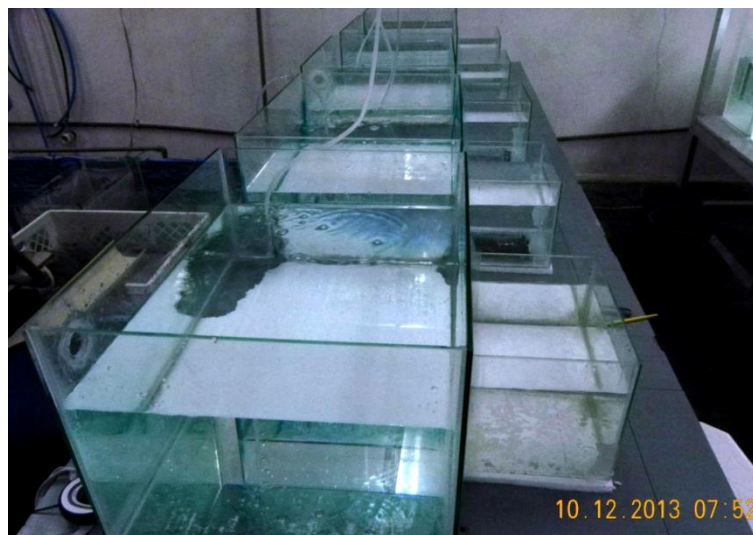
Figura 6 - Bateria de aquários de indução e recuperação anestésica (aquários menores para indução e maiores para recuperação).
