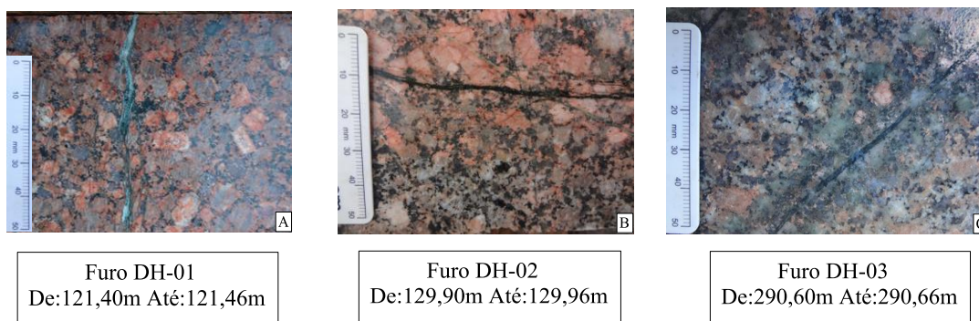
Figura 20 – Amostras de rocha dos três furos estudados com presença de alteração hidrotermal do tipo 2.1. A) Rocha do furo DH-01 com veio de calcita-ilita-clorita-quartzo. B) Rocha do furo DH-02 com veio de clorita-ilita-quartzo e avermelhamento dos feldspatos alcalinos. C) Rocha do furo DH-03 com presença de veio com halo de alteração constituído de clorita-ilita-quartzo.
