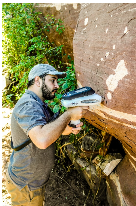
Figura 9 – Levantamento dos perfis quimioestratigráficos com o equipamento de FRXp.
