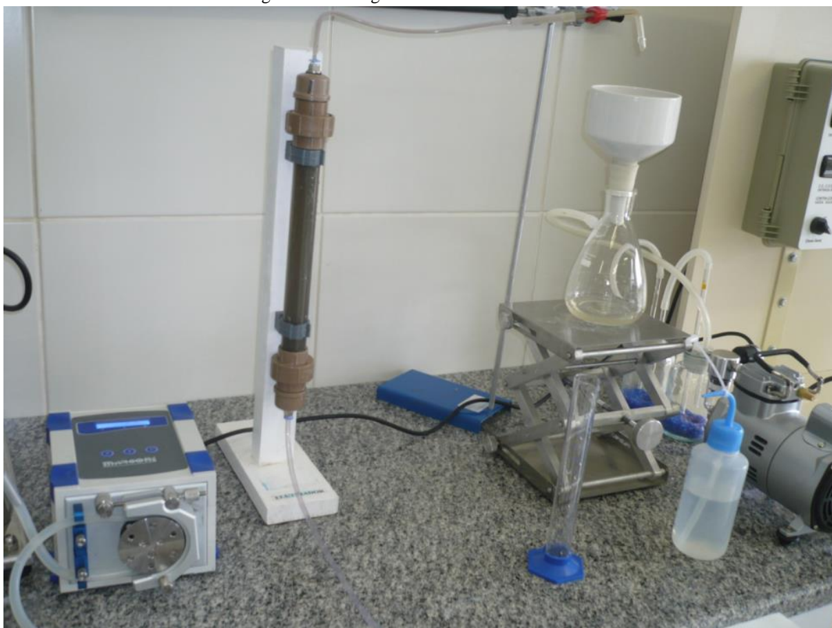
Figura 3.6 - Fotografia ilustrativa do elutriador.
