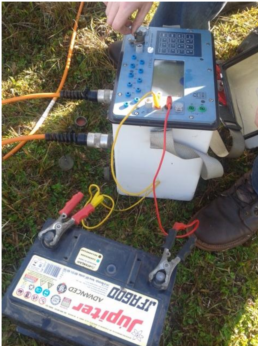
Figura 15 - Eletrorresistivímetro utilizado em campo.
