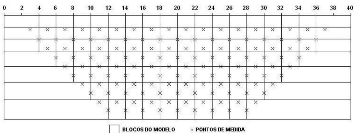
Figura 16 - Exemplo de arranjo de blocos utilizado no modelo, juntamente com a posição dos pontos de medida da correspondente pseudo-seção.
