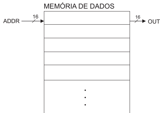
Fig. 6 – Esquemático Básico da memória de dados.
